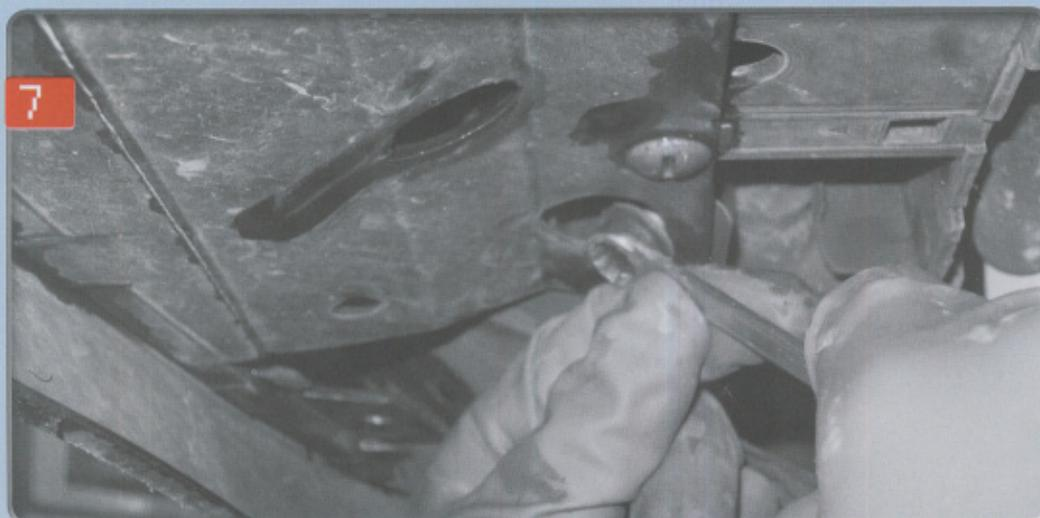
CON UNA CHIAVE DEL 10 RIMUOVIAMO IL DADO DI FISSAGGIO DEL PARASPRUZZI.
