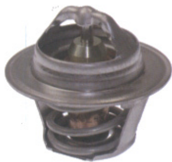
Componenti di distribuzione: il termostato
